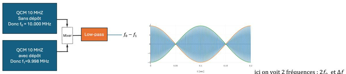
La fréquence de battement peut être mesurée en multipliant la fréquence de résonance du quartz microbalance  $f_0 - \Delta f$  avec la fréquence de référence  $f_0$ . Après filtrage passe bas, on obtient un signal dont la fréquence vaut  $(f_0 - \Delta f) - f_0 = \Delta f$
